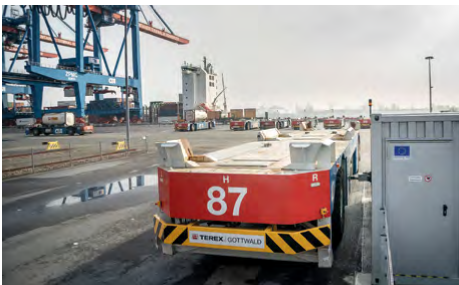
Ein AGV beim Andocken an das allgemeine Stromnetz
